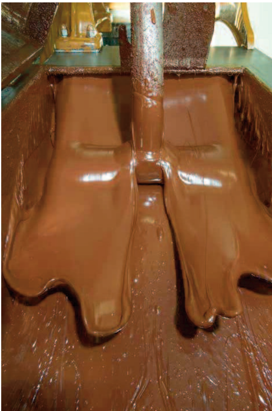
Der Längsreiber funktioniert wie ein Raddampfer. Angetrieben von einem Schwungrad, bewegt der Hebel die Eisenrolle über eine Granitplatte hin und her. Die Reibungswärme weicht die Schokolade auf und fördert ihre innersten Geheimnisse zutage
