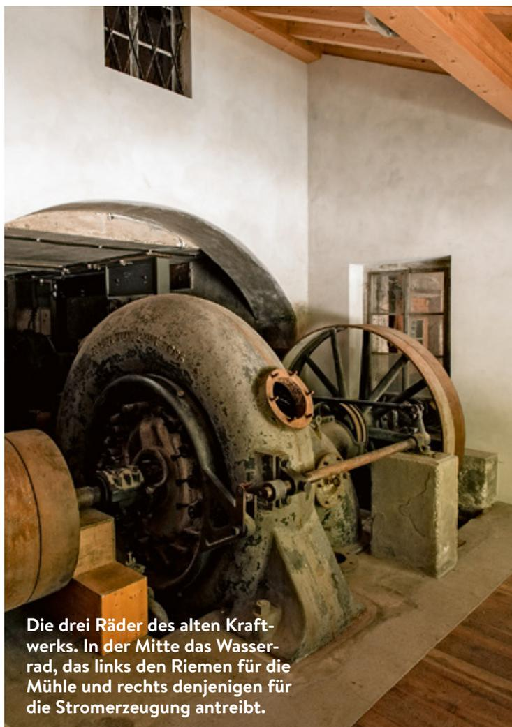
Die drei Räder des alten Kraftwerks. In der Mitte das Wasserrad, das links den Riemen für die Mühle und rechts denjenigen für die Stromerzeugung antreibt.
